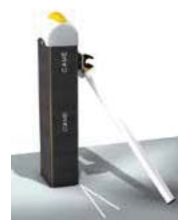
G40403 Attacco porta asta sganciabile BASE. Dopo l'impatto, l'estremità dell'asta sganciata si appoggia a terra.
